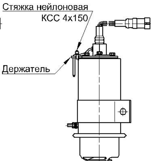
Рис. 1 – Замена поврежденного узла самозапуска или с истекшим сроком службы.
